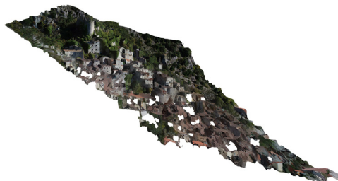
Fig. 6- Profilo territoriale elaborato con il software Agisoft Metashape (elaborazione grafica di M. P. Testa)
