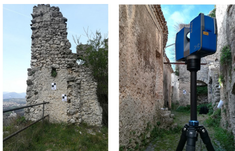
Fig. 7- Laser scanner e targets, fase di campagna (foto di M. P. Testa, 2021)
